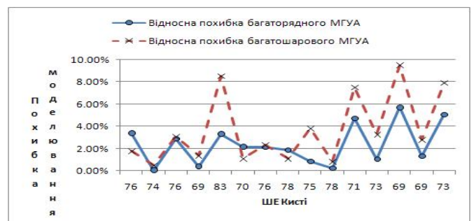
Рис. 2. Результати порівняння відносних похибок за одношаровим алгоритмом синтезу моделей та багат шаровим
