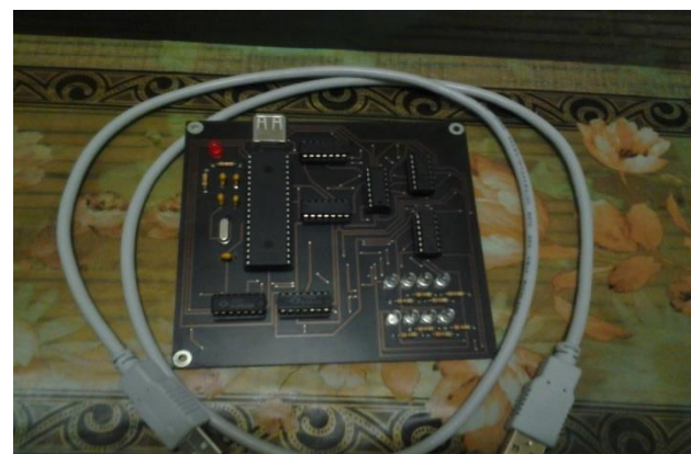
Рис. 18. Дослідний зразок обчислювальної мікросистеми програмно – апаратної корекції помилки
