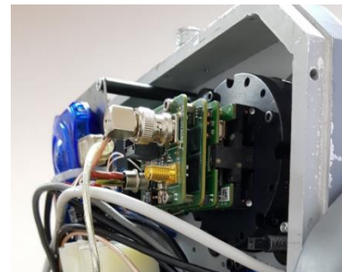
Рис. 3. Електронний модуль тепловізора XTM 640
