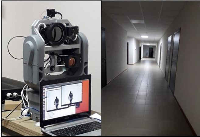
Рис. 6. Лабораторний стенд вимірювання дальності виявлення і супроводу тепловізійної камери, лазерного далекоміра (довжина траси 30 м)
