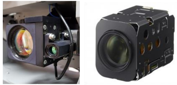
Рис. 2. а) Лазерний далекомір; б) Модульна інтегрована з об'єктивом камера FCB-EV7520
